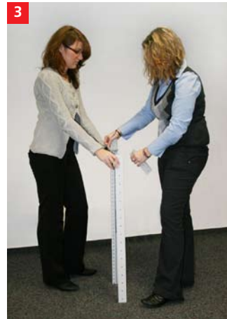
3 Kunststoffaufstockelement auf Rahmen aufstecken
